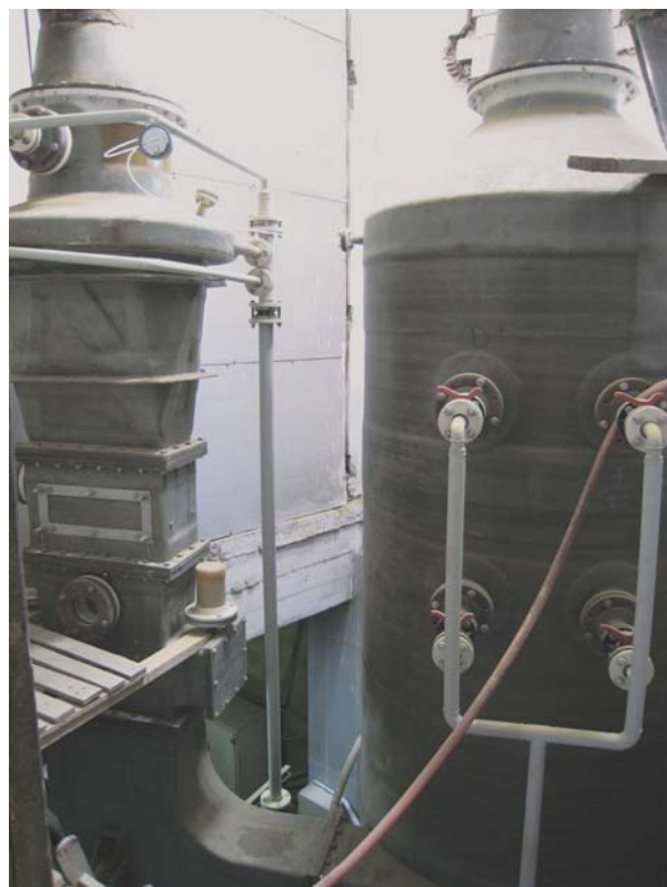
Bild: Venturiwäscher aus GfK mit 20 mbar Druckverlust zur Abscheidung feinsten Zinkoxidstäube und Chloraerosole.
