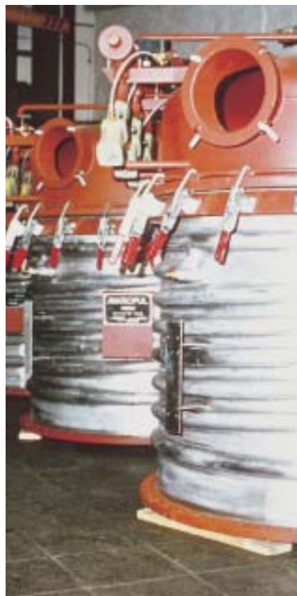
Druckfilter mit Dampfheizung
