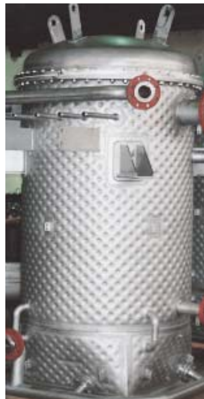
Mikro-Pulsaire mit „Thermpate“-Heizmantelblech und Ringleitung
